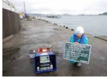
グラブ浚渫船GNSS精度確認
